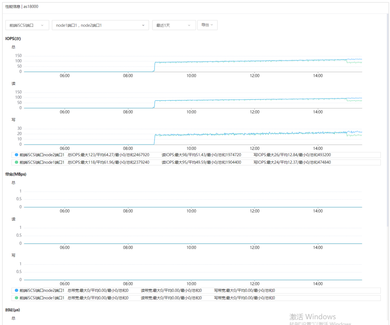
图 4-10 统一存储前端 iSCSI 端口性能历史曲线
